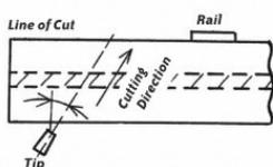
**Mini-Mantis II** обеспечивает высокую точность диагонального реза, чистую и острую кромку. Двухмоторный привод горелки как для резки обеих перегородок, так и полки. Нет необходимости вращать и маркировать заготовку.
