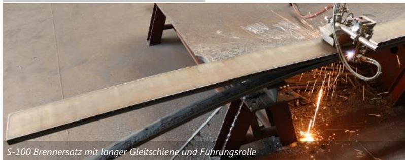
S-100 Brennersatz mit langer Gleitschiene und Führungsrolle
