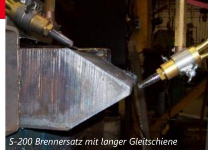
S-200 Brennersatz mit langer Gleitschiene
