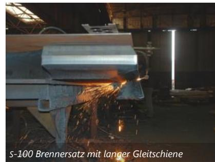
S-100 Brennersatz mit langer Gleitschiene
