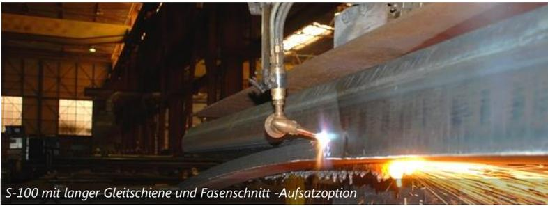
S-100 mit langer Gleitschiene und Fasenschneid-Aufsatzoption
