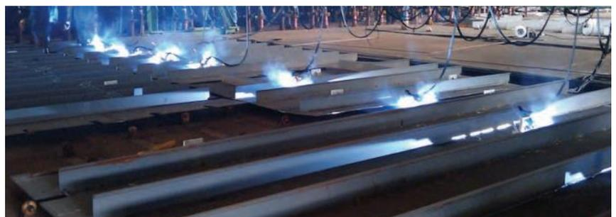
Mehrere Wel-Handy Multis in gleichzeitigem Betrieb
