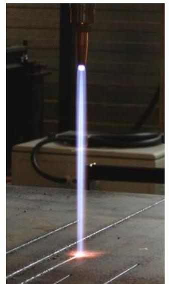
Fort courant d'oxygène de coupe provenant d'une buse divergente : Photo prise du test de performance en interne chez Koike. Pointe de buse à 275 mm au-dessus de la plaque, buse 106-D7#0.
