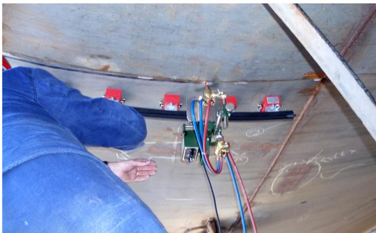
Резка в потолочном положении стала возможной благодаря сильным постоянным магнитам
