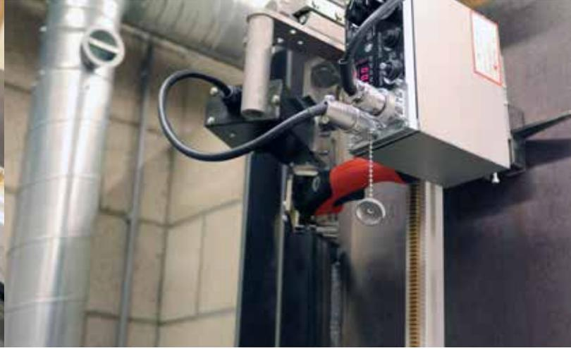
La serie IK-72W viene utilizzata per saldature rettilinee in posizioni orizzontali e verticali utilizzando un binario monodimensionale e saldature su piani curvi e ritorti con binari a 2 e 3 dimensioni. Utilizzando lo stesso sistema di binari della macchina da taglio IK-72T, taglio e saldatura possono essere effettuati con il sistema IK-72 in un pacchetto pratico e leggero.
